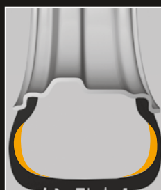
SSR-Pannenlaufreifen Die verstärkten Seitenwände stützen den Reifen bei Luftverlust.
